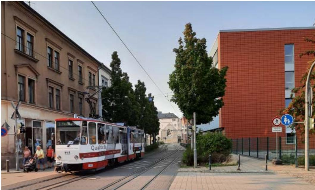
**Abbildung 16: Straßenbahn in der Äußeren Schneeberger Straße mit Dreischienengleis**
