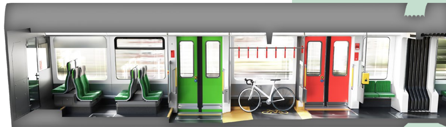
Integrierte multifunktionale Räume bieten Platz für Fahrräder, Trolleys, Gepäck und Rollstühle
